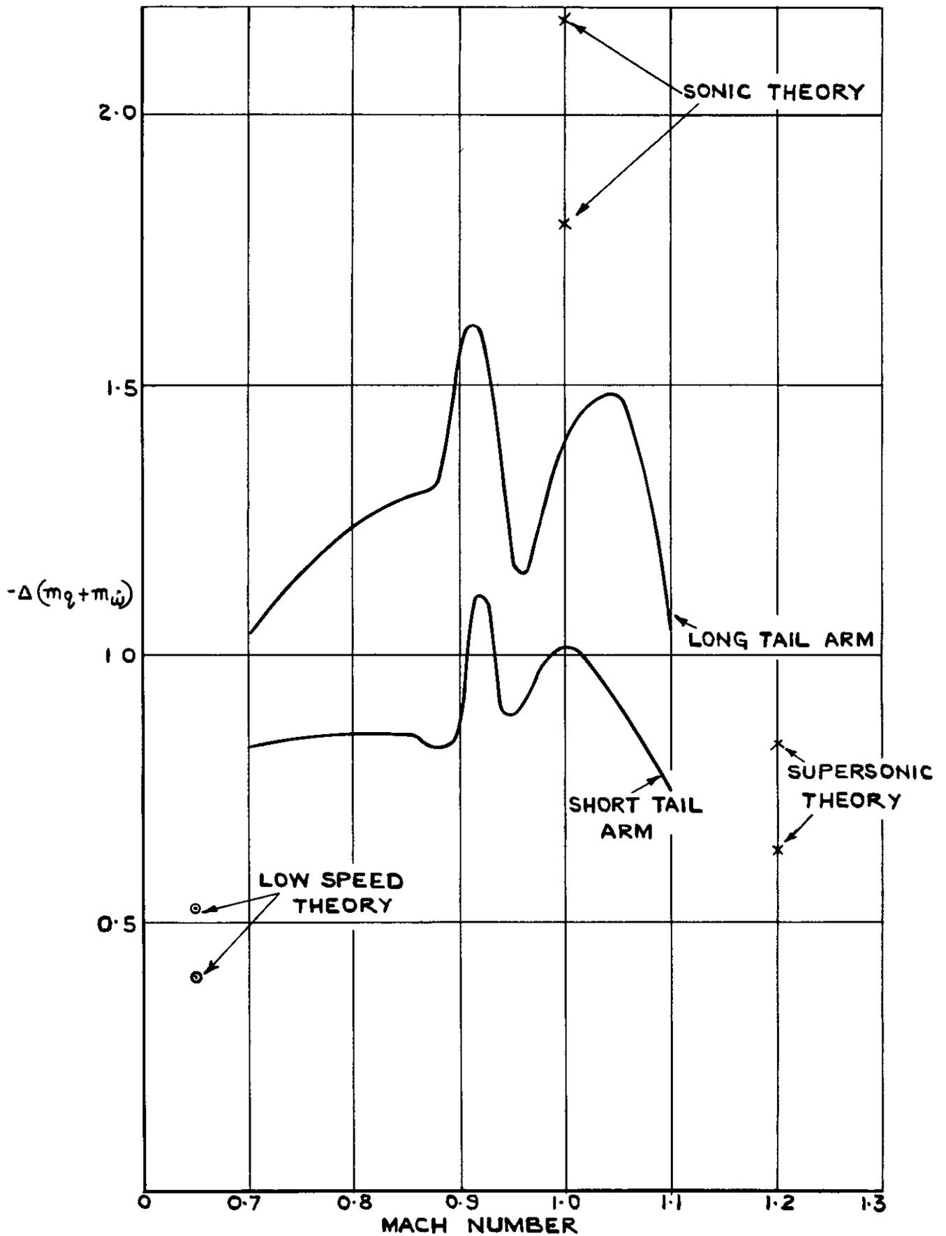
FIG.6.VARIATION OF THE TAILPLANE CONTRIBUTION TO  $-(m_q + m\dot{\omega}_r)$  WITH MACH NUMBER.
