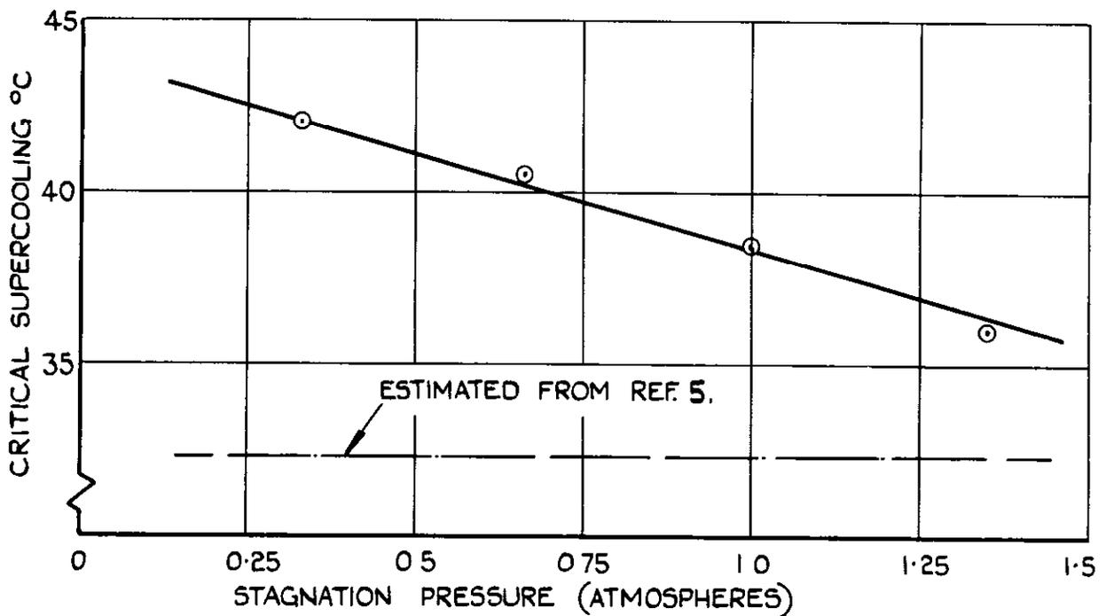
FIG.5. CRITICAL SUPERCOOLING
