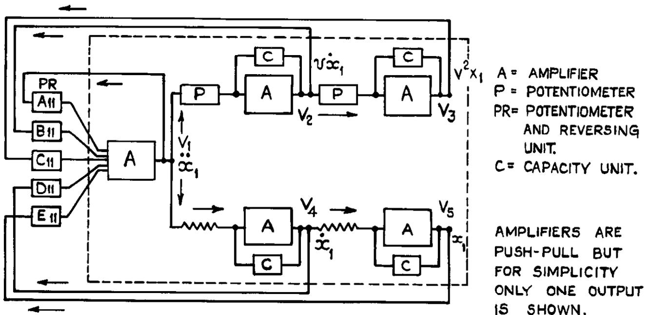
FIG. 7. CIRCUIT FOR ONE DEGREE OF FREEDOM.
